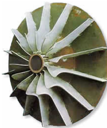
Figura N° 7.8 – Rodete de un ventilador centrífugo con alabes rectos
